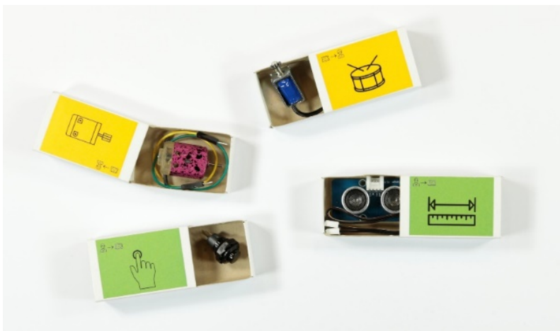
Abb. 3: Zubehör-Boxen mit Materialien für die Eingabe (grün: Taster und Ultraschalldistanzmesser) und Ausgabe (gelb: DC-Motor und Hubmagnet)
