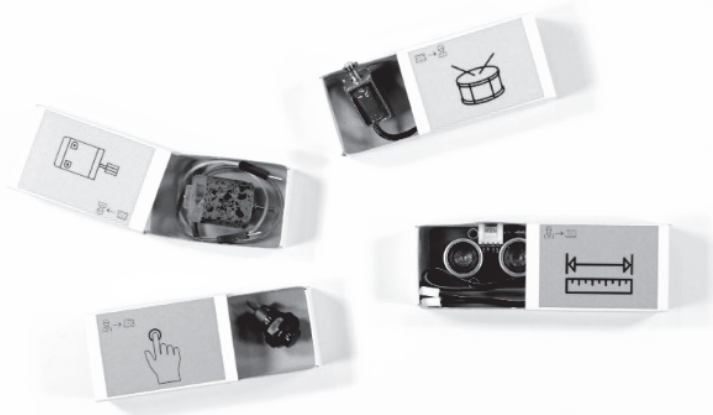
Abb. 3: Zubehör-Boxen mit Materialien für die Eingabe (grün: Taster und Ultraschalldistanzmesser) und Ausgabe (gelb: DC-Motor und Hubmagnet)
