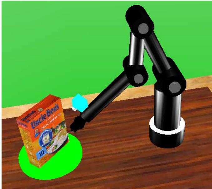
Abb. 3.9: Dreidimensionales Modell des Roboterarms und eines Objektes mit realistischer Textur in der VR-Toolbox
