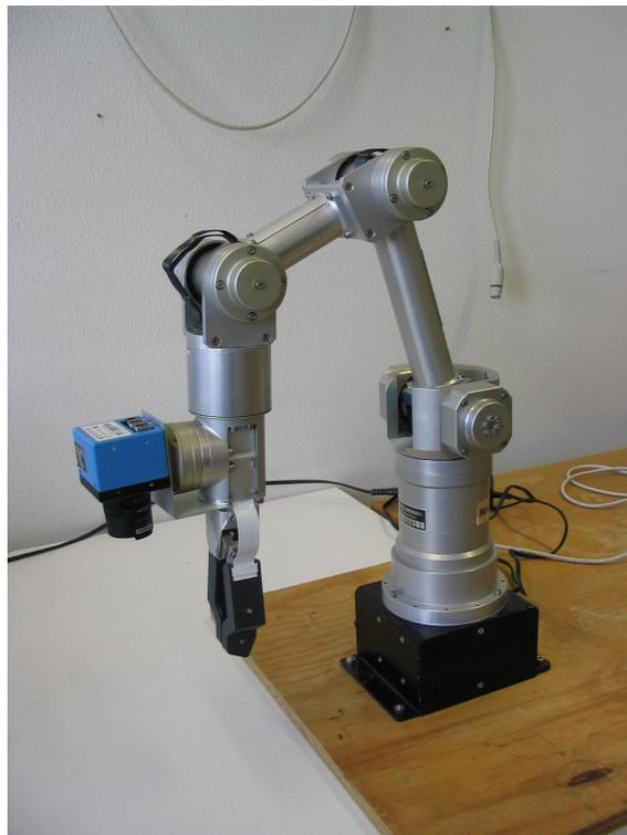
Abb. 9.1: Roboterarm „Katana HD5M“ mit Kamera
