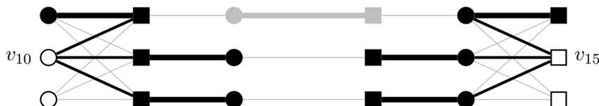
**Abbildung 5.6:** Ein Worst-Case-Graph für AUGTREES (3/3). Schwarze Kanten gehören zu alternierenden Bäumen, dick gedruckte Kanten sind Matching-Kanten. Zeilen sind Kreise, Spalten sind Quadrate.
