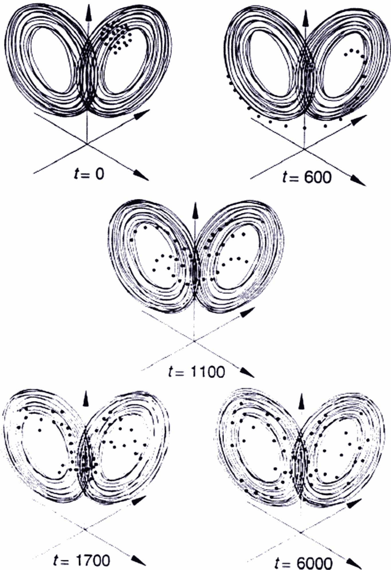
**Abb. 3.11** Trajektoriebilder für den chaotischen Lorenzattraktor. Infolge der exponentiellen Divergenz der Trajektorien wird eine Wolke von zunächst benachbarten Zuständen sehr schnell über den ganzen Attraktor verstreut. Der genaue Zustand ist somit nach Verlauf einer gewissen Zeit kaum noch vorhersagbar.
