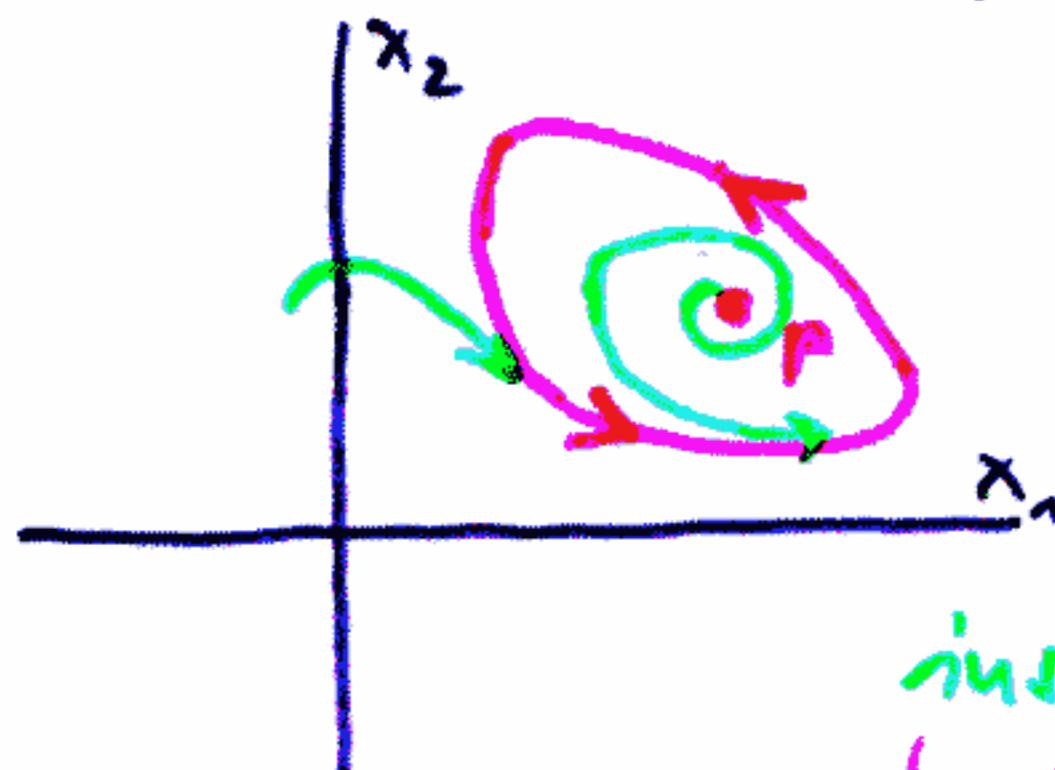
alle Bahnen münden in einen (stabilen) Grenzzyklus, der einen instabilen Fixpunkt  $P^0$  umgibt (entdeckt von Poincaré)
