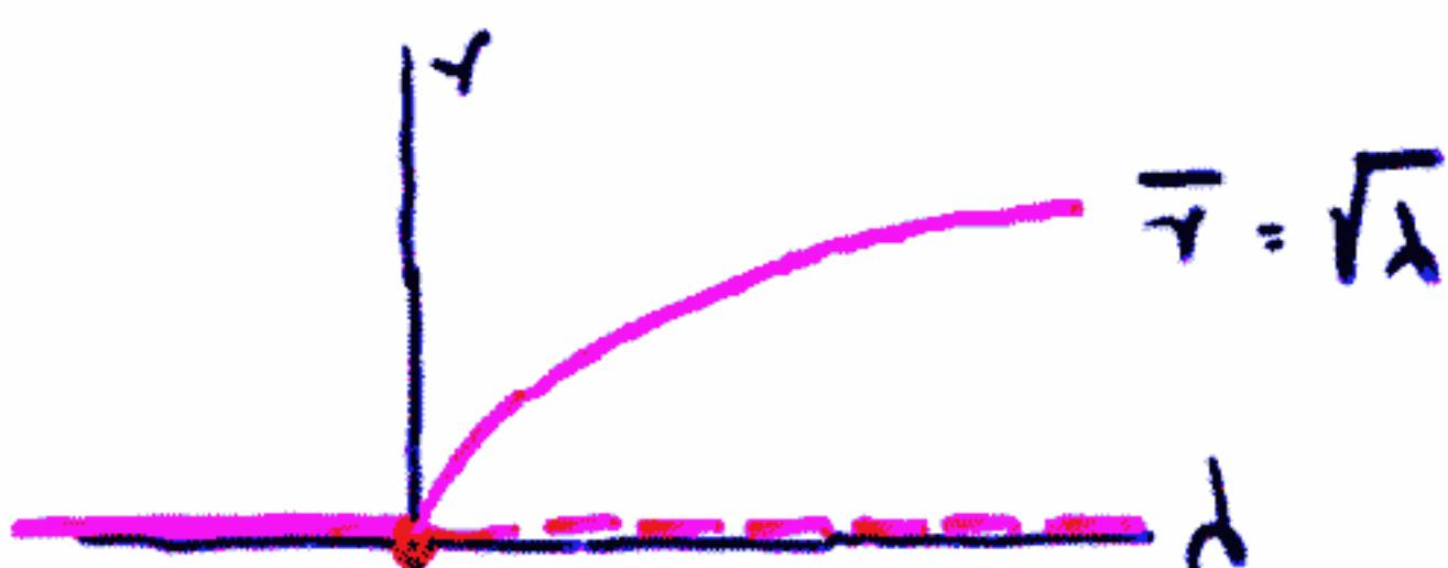
für  $\lambda < 0$  ist  $\bar{\tau} = 0$  (d.h.  $\begin{pmatrix} x_1 \\ x_2 \end{pmatrix} = \begin{pmatrix} 0 \\ 0 \end{pmatrix}$ ) ein stabiler Fixpunkt
